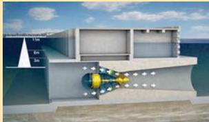
abertas e a água passa pelas turbinas, gerando energia e enchendo a barragem.
